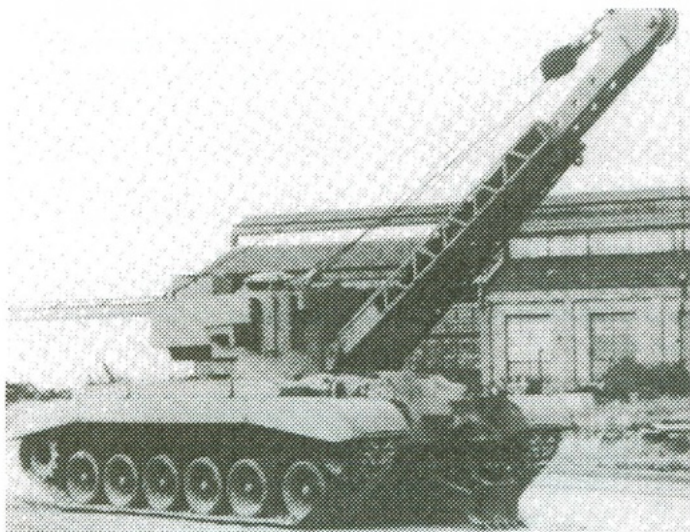
De T12 woog 40 ton, was 7½ m lang en werd in 1944 gebouwd.
